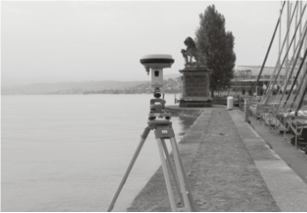
Satellitengestützte Vermessung mit GNSS-Station. (Bild: GeoZ)
